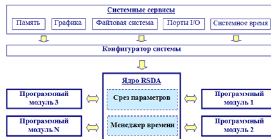
рис. 1 Структурная схема открытого кросс-платформенного комплекса РСДА.
